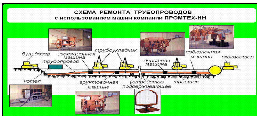
Сурет 2. Тіректердегі траншеядағы құбырды жөндеу схемасы
