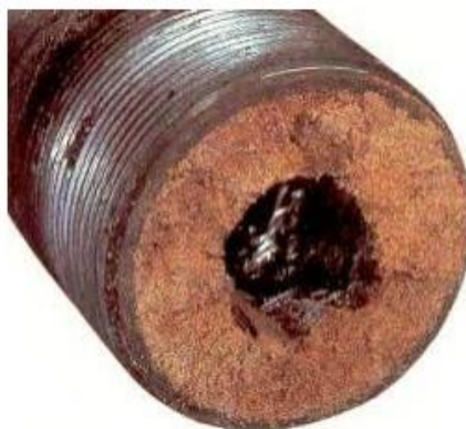
Сурет 1 – Сорғы-компрессорлық құбырларға жабысқан АШПШ
